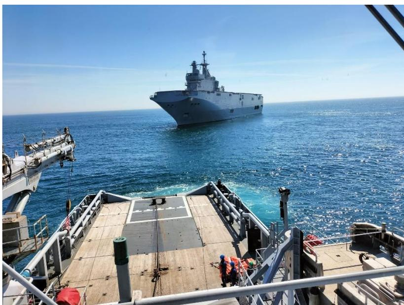
Dans ce dernier, contrairement à un remorquage dit « classique », la remorque est entièrement fournie par le remorqueur. Une fois le gréement en acier mis en place, le BSAM est monté progressivement jusqu'à une vitesse de 6 nœuds (vitesse maximale en exercice), a réalisé des abattées de 100 degrés et
